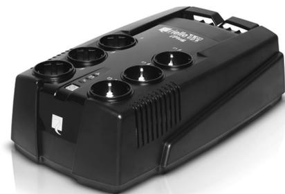
Riello iPlug 800VA. Capacidad de potencia de salida (VA): 0,8 kVA, Potencia de salida: 480 W, Voltaje de entrada de operación (min): 220 V. Tipo de salida AC: C13 acoplador, Cantidad de salidas AC: 8 salidas AC. Tecnología de batería: Sealed Lead Acid (VRLA), Tiempo de recarga de la batería: 8 h. Factor de forma: Compacto, Color del producto: Negro, Seguridad: EN 62040-1-1, Directive 2006/95/EC; EN 62040-3. Ancho: 185 mm, Profundidad: 313 mm, Altura: 99 mm
